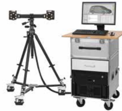
光学式3Dカメラによる変位計測システムで計測
