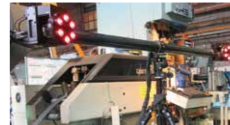
光学式3Dカメラによる変位計測システムで計測
