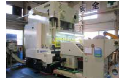
アイダ・C2-200 プレス制御、トランスファ制御を一括管理でシンプル化
