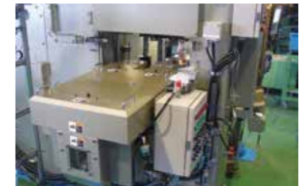
小松・L1C-400 過負荷防止機能搭載の長寿命タイプ(特許取得済)
