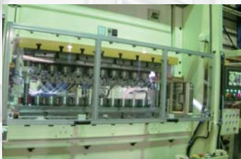
[事例1] 10 工程エンジンバルブ成型ライン
